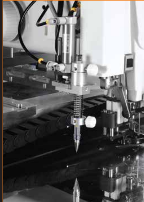
占筆功能：可根據編輯的花樣程序在縫制物上任意點畫輪廓線、點，為下道工序的縫制作好準備，可為服裝工藝減少工序減少勞動力。 點筆裝置具備防點死功能（有彈簧緩衝），防止點筆筆芯易斷，同時防止損傷縫制物品。
