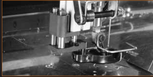
雙導杆氣動大壓腳裝置，行程達15mm；可保證在縫紉過程中壓制模板以更穩地壓緊縫制物，同時較大的行程可保證模板取放方便。
